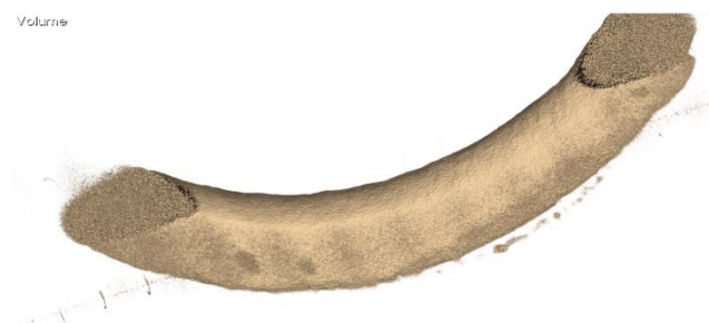
Figure 4.2 : Résultats obtenus après radiographie neutronique (a) image reconstituée par imageJ après rayonnement de neutrons (b) représentation 3D par VolView du cordon seul. Échantillon FNC 11.
