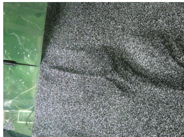
(b) Morphologie du lit sédimentaire obtenue pour un débit Q_f = 20 L/s et une incidence fixe du profil ( 20^\circ ).
