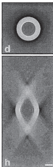
FIGURE 2.15 – Reconstruction de mesures expérimentales sur une bille creuse de 10 \mu\text{m} ayant des fluorophores en surface, en prenant en compte la Point Spread Fonction mesurée de l'objectif à immersion à huile \times 100 . En (d) cartographie transverse (x, y) et en (h) coupe optique dans le plan (x, z) emprunté dans l'article de N. McNally et al. [82].
