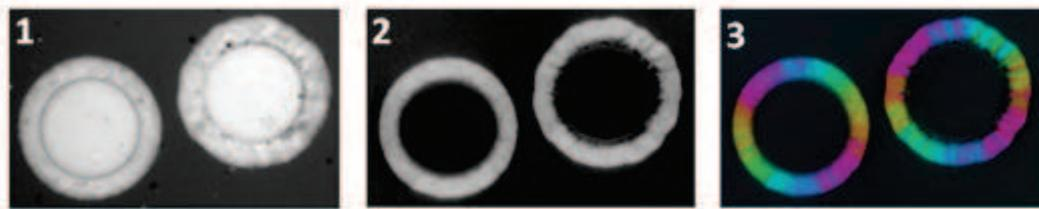
FIGURE 1.27 – Analyse MOLP d'un dépôt de pyrocarbone. 1 : Fibre de carbone et son dépôt de matrice de pyrocarbone. 2 : Angle d'extinction représentant l'anisotropie. 3 : Orientations préférentielles du dépôt.
