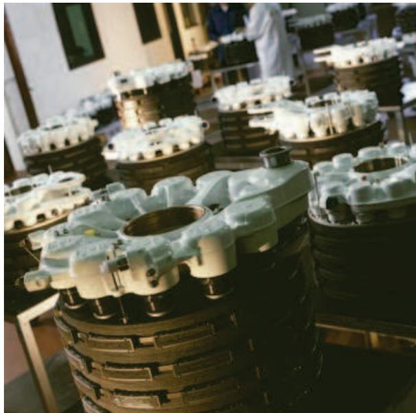
FIGURE 2 – Freins d'avions en composite carbone/carbone (source : Safran Landing Systems).
