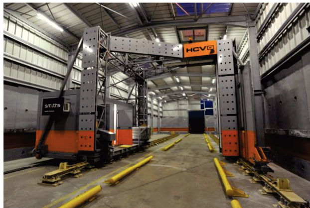
Figure 5 – Système d'imagerie HCVG
