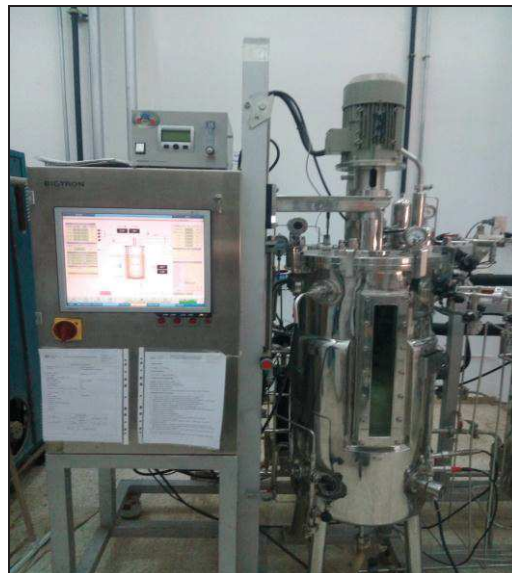
Figure 95. Fermenteur de 100 litres contenant 60 litres de culture FLU5 dans le milieu ME, à 37°C.
