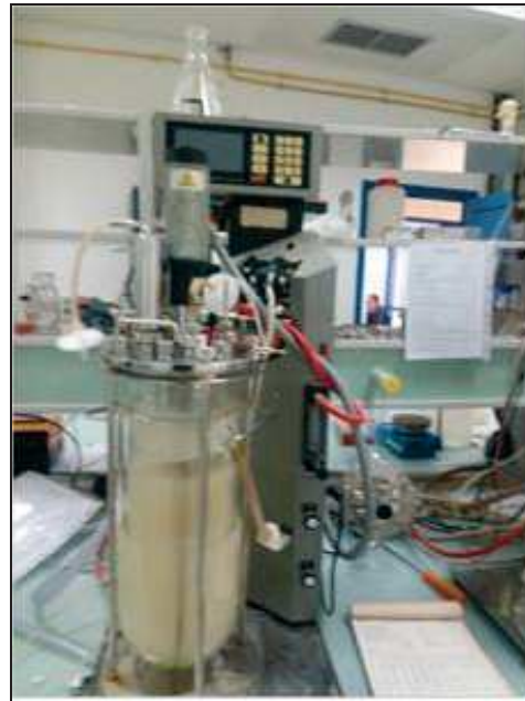
Figure 92. Fermenteur de 20 litres contenant 5 litres de culture FLU5 dans le milieu ME, à 37 °C.
