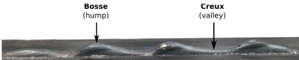
Figure 3.1.2 Défaut de « humping » dans un cordon déposé avec une grande vitesse de déplacement
