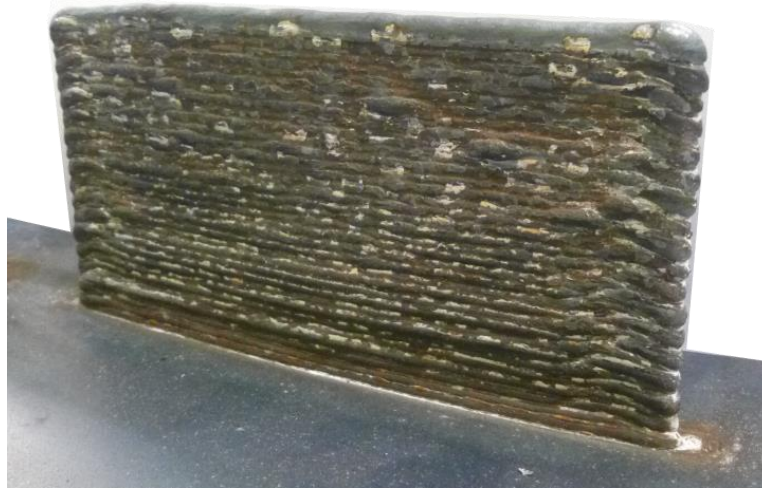
Figure 4.2.2 (a) Mur fabriqué avec la stratégie utilisant le même sens de dépôt, et (b) mur fabriqué en utilisant la stratégie alternée de dépôt.
