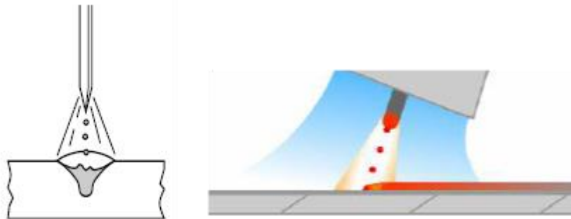
Figure 1.16.3. Représentation schématique du transfert par pulvérisation axiale (ou spray)
