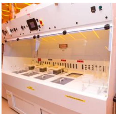
Figure 31 : Exemple d'une paillasse chimique de type RCA ayant servi à la préparation des couches minces déposées
