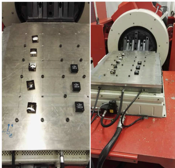
Figure 4-25 :Essai de vibration selon l'axe X
