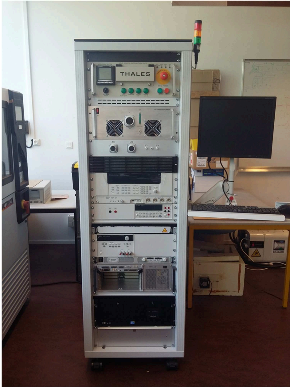
Figure 4-5 : Banc de test de la fonction alimentation
