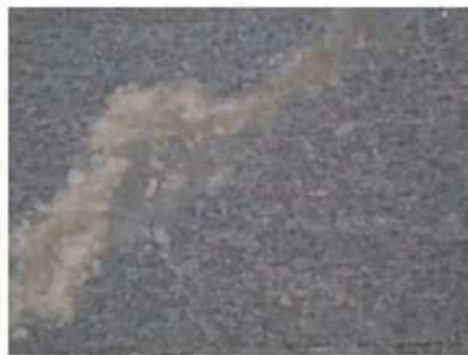
Figure 1-23 : Des défauts sur l'anode d'un condensateur vieilli
