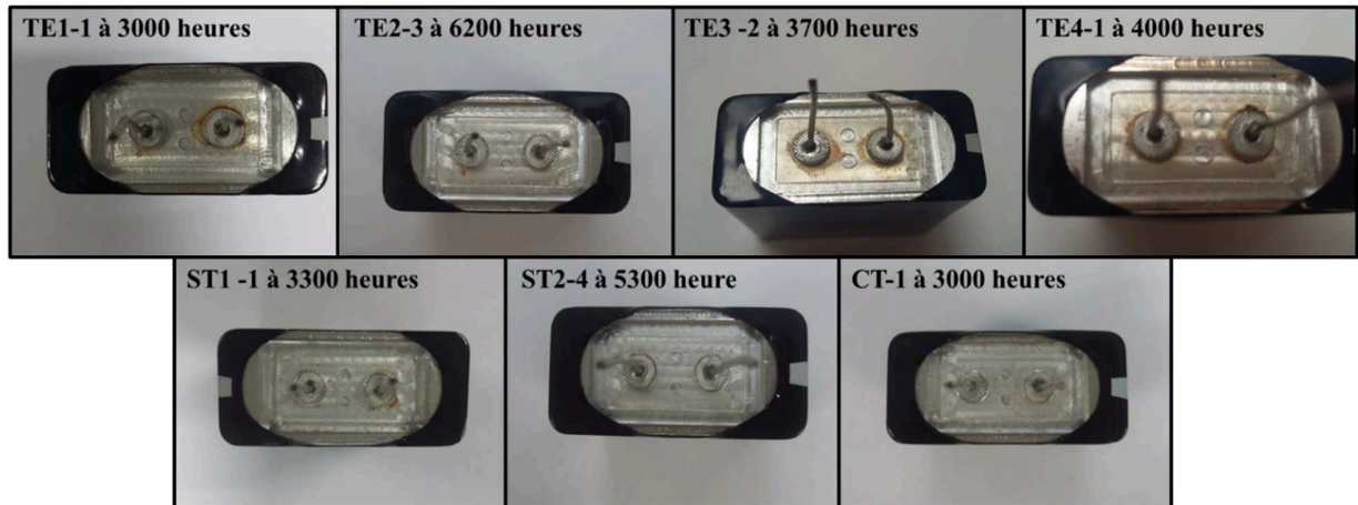
Figure 3-4 : Fuite d'électrolyte à travers les bornes d'un condensateur ayant subi des essais de vieillissement
