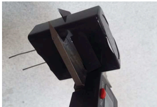
Figure 2-4 : Mesure de l'épaisseur du boîtier du condensateur
