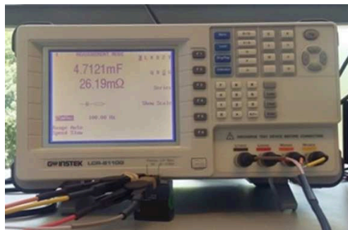
Figure 2-1 : Mesure de la capacité et de l'ESR avec un LCR-mètre
