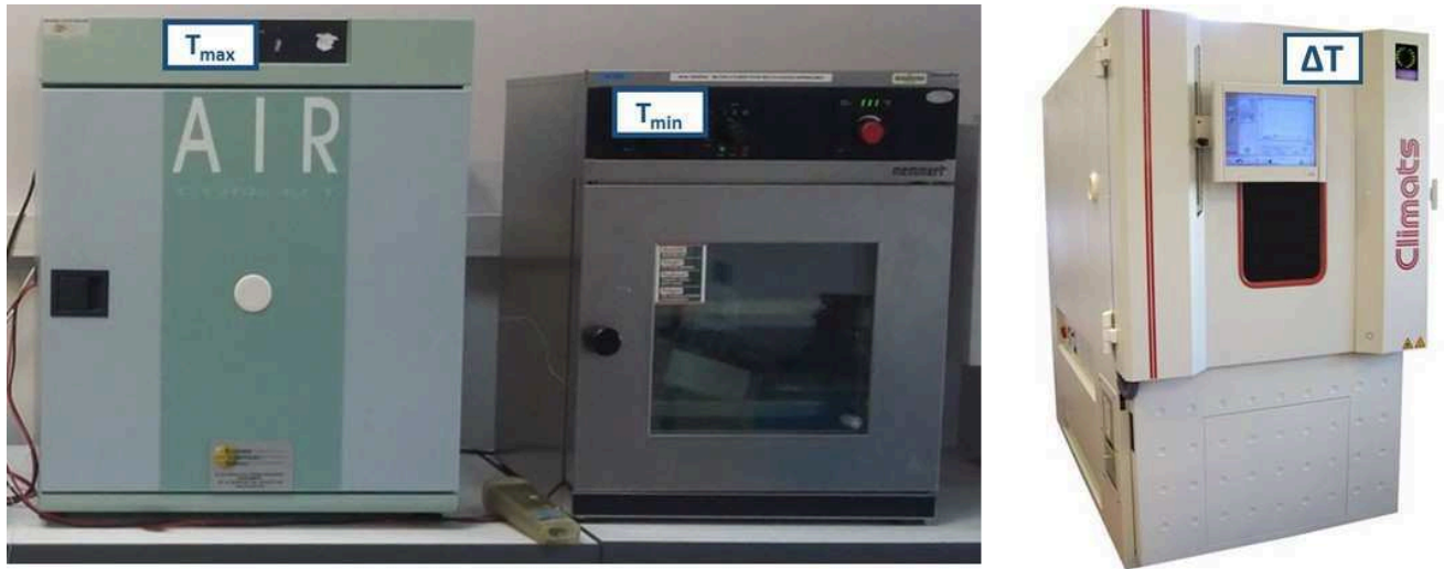
Figure 2-9 : Enceintes climatiques utilisées lors des trois essais thermiques (ST-1, ST-2 et CT)
