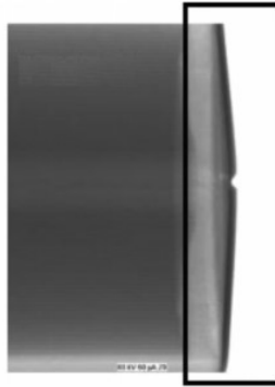
Figure 1-22 : Image aux rayons X montrant la déformation du boîtier [31]
