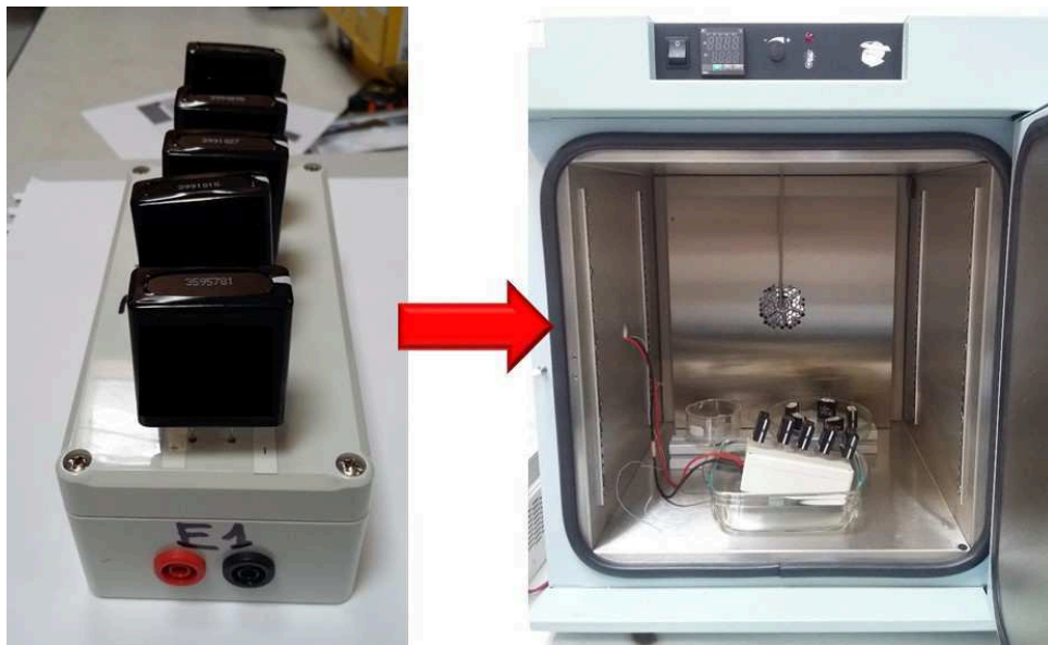
Figure 2-13 : Mise en place des condensateurs pour un test thermoélectrique
