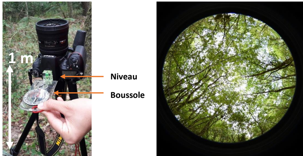
Figure 50 : Méthode de prise de photos hémisphériques
