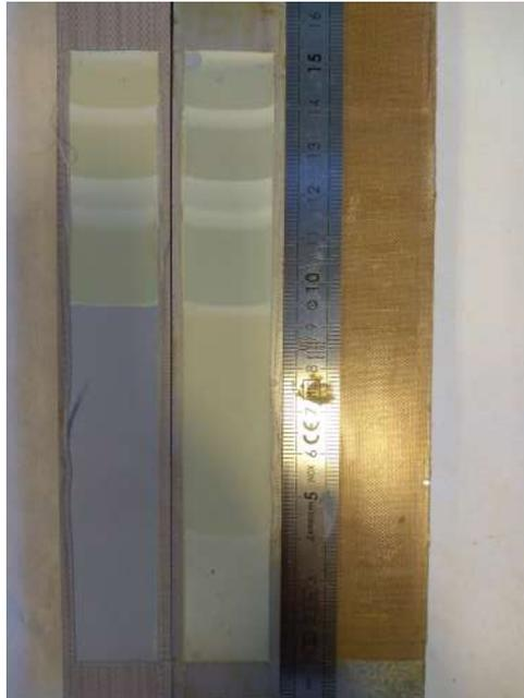
FIGURE 4.30 – Substrats après test DCB appliqué à un assemblage collé contenant sur une moitié de sa surface une pollution au PTFE.
