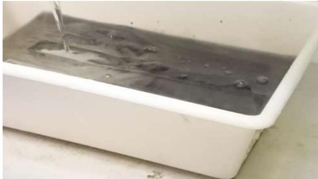
FIGURE 4.2 – L'acide nitrique est versé sur les échantillons pour dissoudre la couche noire oxydée.
