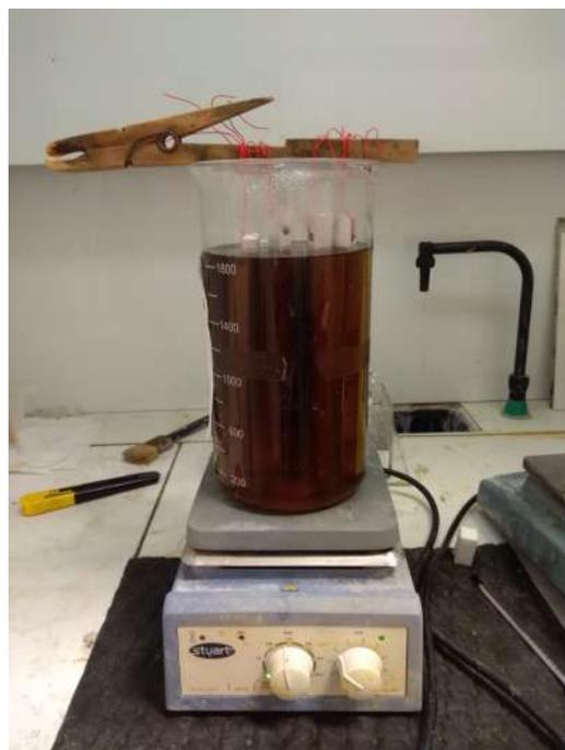
FIGURE 4.3 – Les échantillons trempent dans la solution pendant 10min.
