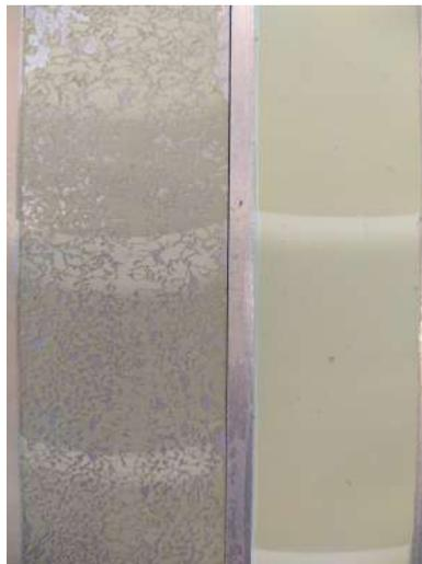
FIGURE 4.9 – Faciès des substrats après test DCB, sur échantillon mal collé (mauvaise mise sous contrainte, à gauche) et échantillon bien collé (bonne mise sous contrainte, à droite).
