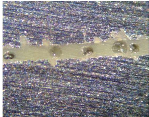
(b) Mauvaise cuisson, des porosités apparaissent.
