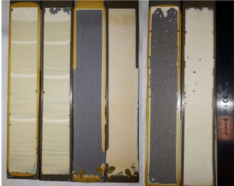
FIGURE 4.42 – Photo des échantillons d'assemblages collés après test DCB avec respectivement de gauche à droit : le cas nominal (sans pollution), l'échantillon avec une interface polluée au PTFE, et le dernier étant l'échantillon avec l'interface polluée au démoulant.
