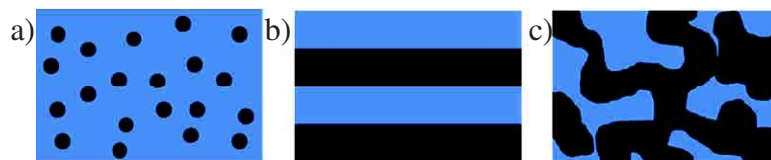
Figure I-5 : Schéma d'une morphologie de type : a) nodulaire ; b) lamellaire ; c) co-continue
