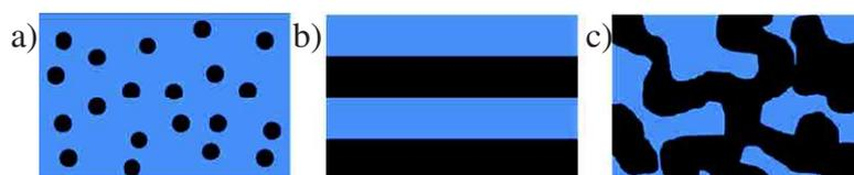
Figure I-5 : Schéma d'une morphologie de type : a) nodulaire ; b) lamellaire ; c) co-continue
