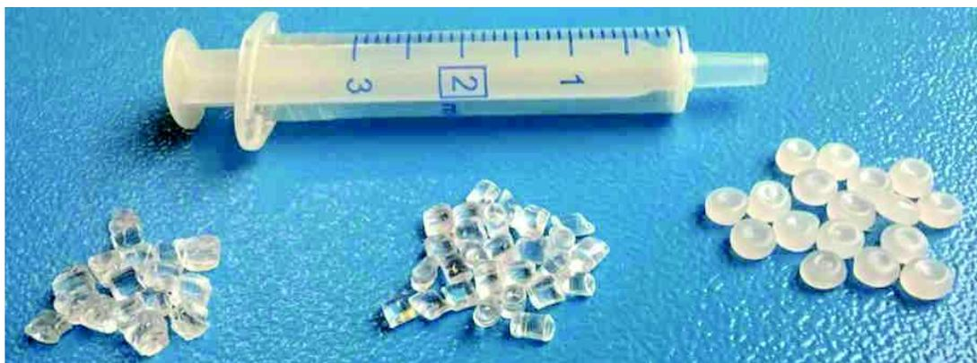
**Figure II-4 : PMMA VM100, PS 143E et PE 003 dans leur forme commerciales de granules**
