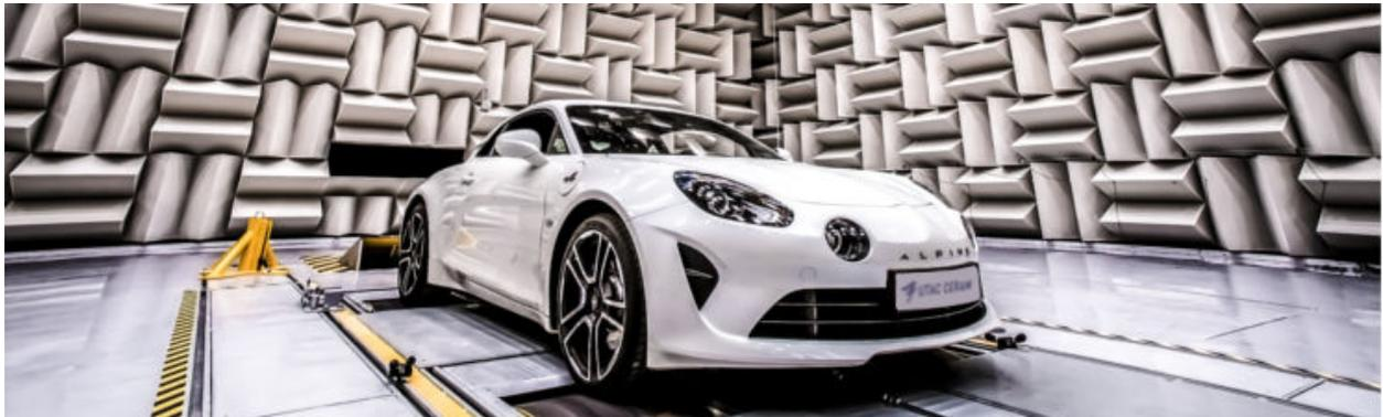
FIGURE 2.14 – Simulation en intérieur sur le banc à rouleau de l'UTAC CERAM<sup>4</sup>
