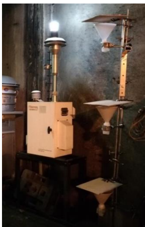
Figure 14 : Partisol installé dans le tunnel (à gauche) et préleveurs passifs de dépôt sec fixés à différentes hauteurs (à droite)
