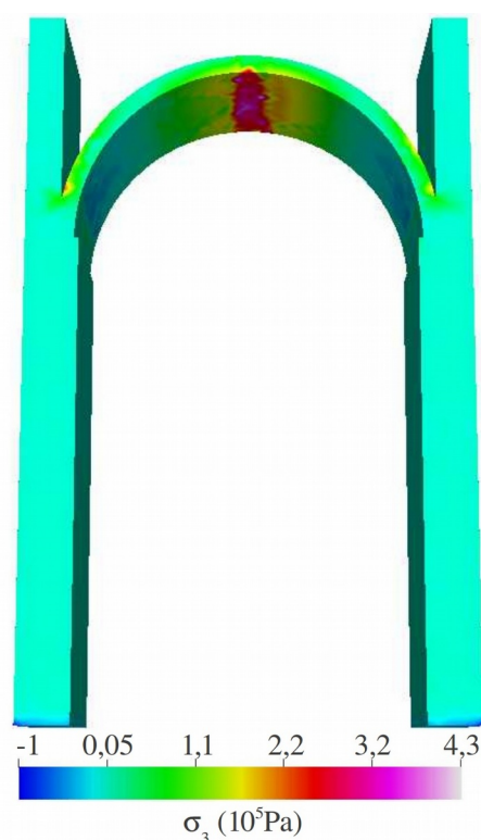
Figure 51. Les tractions dans la voûte, comme sur la Fig. 50, mais en supposant une voûte en plein cintre.
