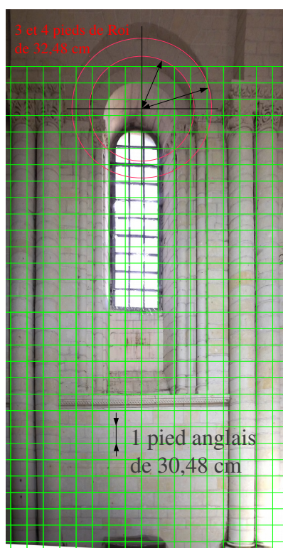
Figure 46. Élévation nord du chœur, et modules en pieds.
