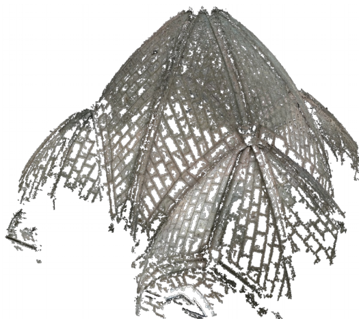
Figure 114. Modèle numérique tridimensionnel de l'intrados de la voûte angevine du clocher.
