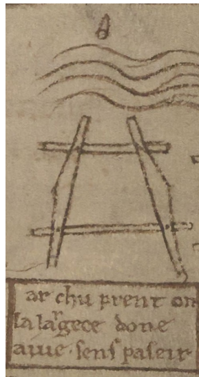
Figure 11. Villard de Honnecourt : Par chu prent on la largece d'one aive sens paseir 19 .
