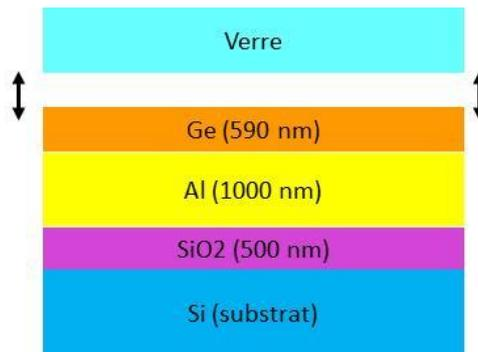
Figure 3.8 : Schéma de l'empilement utilisé pour réaliser un collage avec une plaque en verre.
