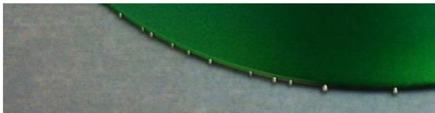
Figure 5.2 : Photographie de la bordure d'un collage montrant des billes de métal révélatrice d'une fuite de l'alliage liquide durant le scellement.
