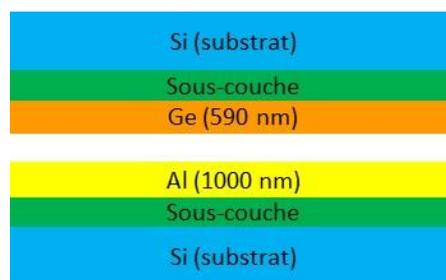
Figure 5.30 : Schéma d'une structure de collage hybride.
