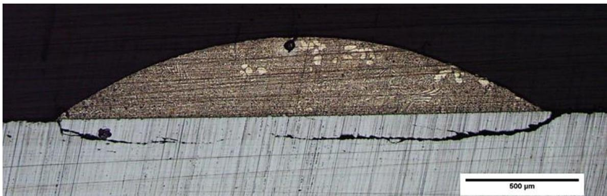
Figure 0.16 : Microscopie optique d'une goutte d'Al-Ge déposée à 450°C sur un substrat Si/TiN (50 nm)/Au (50 nm) puis refroidit après un palier de 45 min.
