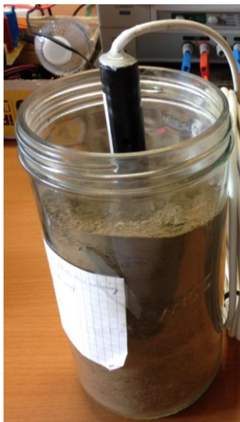
Figure 12 : Tests d'un capteur dans un pot calibré
