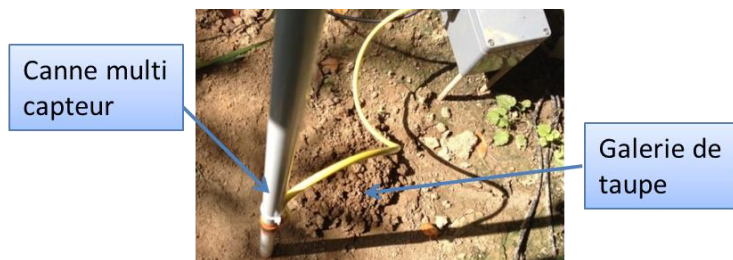
Figure 94 : Photo d'une galerie de taupe proche de la canne multi capteur
