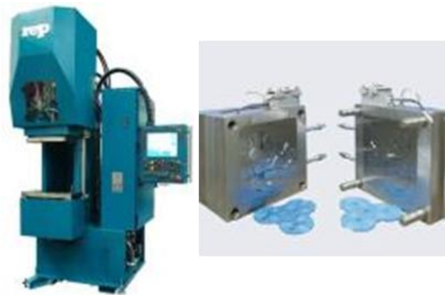
Figure 75 : Presse à injection (à gauche) et moule en métal (à droite)
