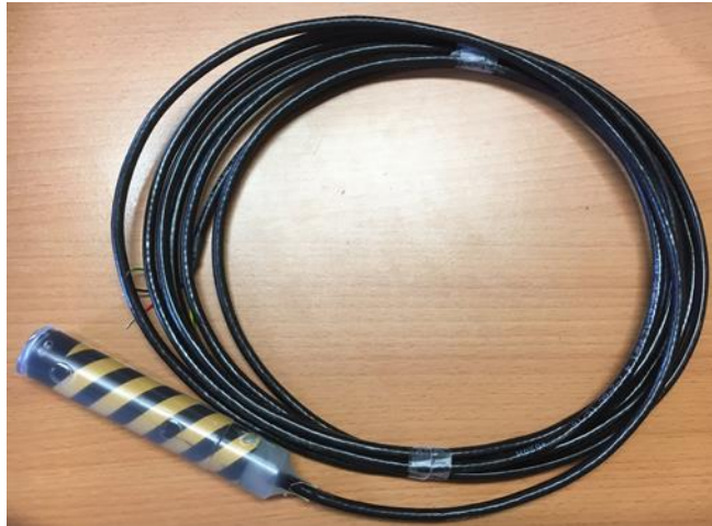
Figure 104 : Nouveau design du capteur surmoulé
