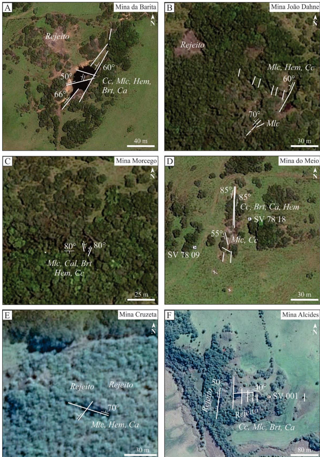
Figura 25. Imagens de satélite com detalhamento em planta das mineralizações (linhas brancas). A) Mina da Barita; B) Mina João Dahne; C) Mina do Morcego; D) Mina do Meio; E) Mina Cruzeta; F) Mina Alcides. Chaves: Cc = calcocita, Mlc = malaquita, Hem = hematita, Brt = barita, Ca = calcita. Figuras B, C e D mod. de Reischl (1978). Fonte: Google Earth .
