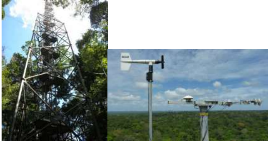
Figure 3 : Le dispositif de mesures des échanges de gaz entre forêt et atmosphère, à gauche, vu d'en bas et à droite : capteurs et appareils de mesure présents au sommet de la tour. Source : photos personnelles, 2010.
