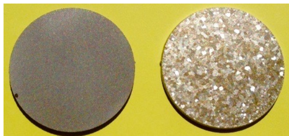
Figure 4.25 : Photos de l'échantillon sablé vierge TA6Vs_ref (à gauche) et de l'échantillon sablé TA6Vs_5A après la mesure de l'émissivité sous vide jusqu'à 1651 K (à droite)
