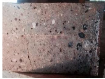
Figure 77 A gauche : sur-cuisson (overfiring) de briques ayant entraîné des fusions partielles. A droite : phénomène de gonflement (bloating) lié à de la matière organique ou des sulfates en excès. Ce sont des défauts connus sur les briques argileuses, et introduits dans les contrôles qualité des industries de la construction ( Defects Bricks Identification - TheConstructor.org )
