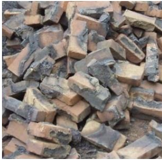
Figure 77 A gauche : sur-cuisson (overfiring) de briques ayant entraîné des fusions partielles. A droite : phénomène de gonflement (bloating) lié à de la matière organique ou des sulfates en excès. Ce sont des défauts connus sur les briques argileuses, et introduits dans les contrôles qualité des industries de la construction ( Defects Bricks Identification - TheConstructor.org )
