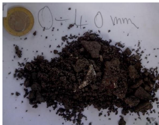
Figure 51 Mâchefer brut LN 0-40, humide. On remarque notamment le fort étalement granulométrique, ainsi que la présence d'éclats de porcelaine sanitaire
