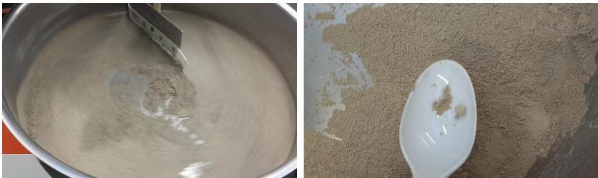
Figure 68 Granulateur à plateau tournant en activité (à gauche) et mélange granulé (à droite)
