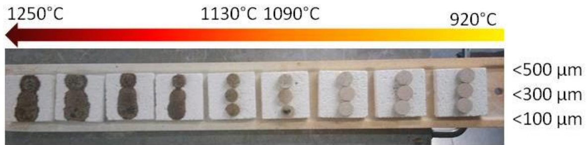
Figure 66 Pastilles de mâchefer de différentes granulométries, cuites au four gradient entre 920 et 1250°C
