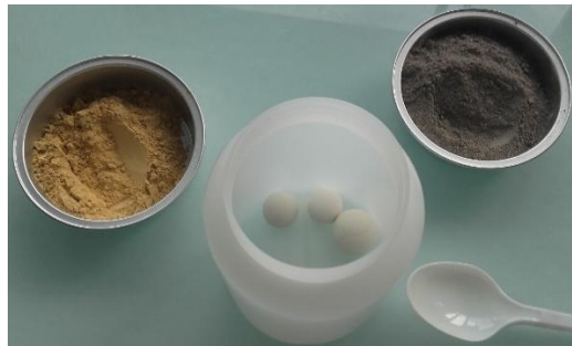
Figure 67 Echantillons de poudres d'argile SD et de mâchefer broyé, avant le mélange
