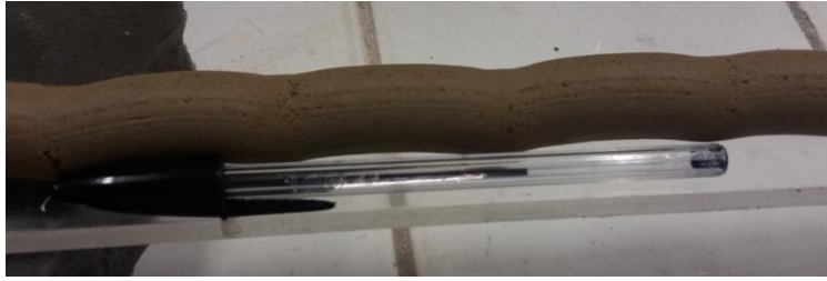
Figure 86 Corps verts issus de formulation à 20, 30 et 40%ms d'argile, avec ajout de plastifiant
