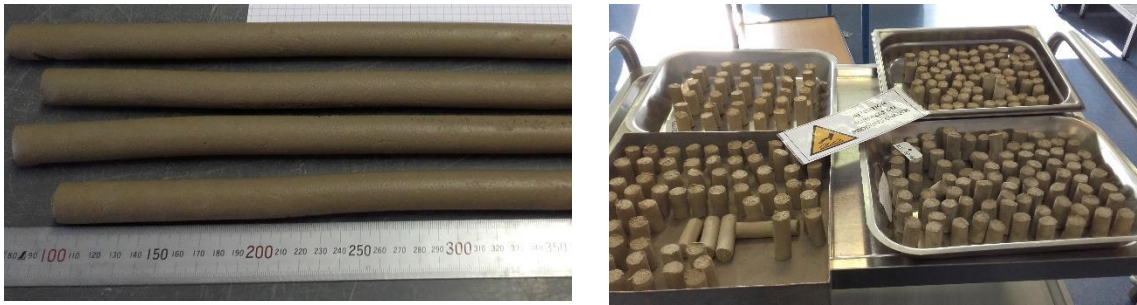
Figure 89 Cylindres extrudés crus (40%ms d'argile), et lots d'échantillons secs
