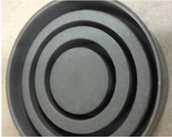
Figure 62 Détail du broyeur à anneaux (à gauche), et dispositif de broyage (à droite)
