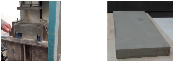
Figure 69 Presse hydraulique utilisée (à gauche) et corps vert pressé (à droite)
