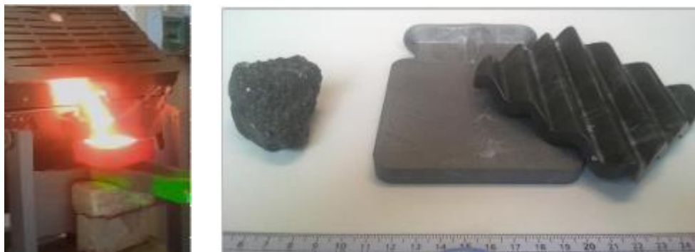
Figure 29 Coulée et échantillons de Cofalit brut et de céramiques (Meffre 2013)
