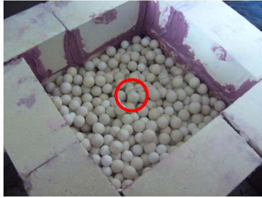
Figure 102 Intérieur de la veine d'air, avec le thermocouple d'entrée dans la veine permettant le suivi de T_h(t) .
