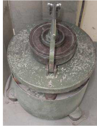
Figure 62 Détail du broyeur à anneaux (à gauche), et dispositif de broyage (à droite)
