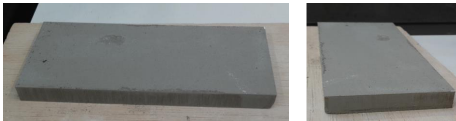
Figure 70 Corps vert, échantillon E01 (poudre de mâchefer <100µm)
