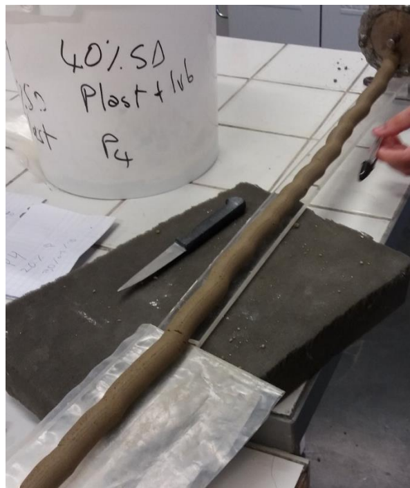
Figure 87 Corps vert extrudé à 40%ms d'argile, avec plastifiant et lubrifiant
