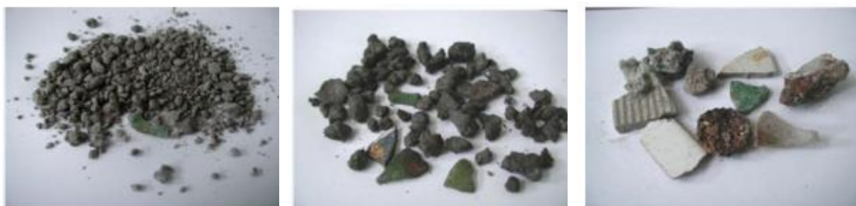
Figure 39 Fractions 0-6, 6-12,5 et 12,5-20mm de mâchefer (Becquart et al. 2009)
