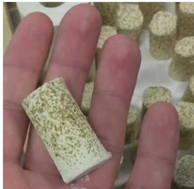
Figure 90 Echantillon cuit à 1100°C. La poudre blanche est l'alumine utilisée comme lubrifiant échantillon/support
