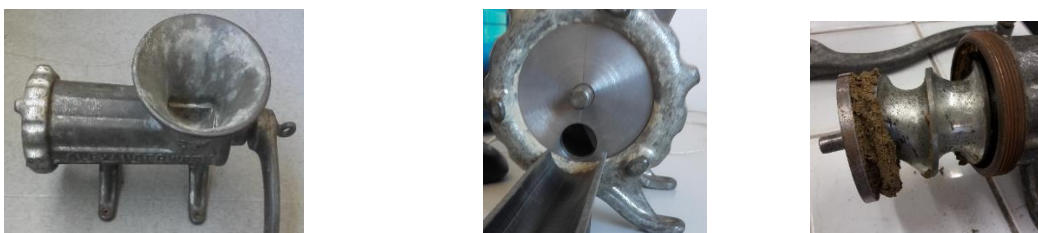
Figure 84 De gauche à droite : vue générale de l'extrudeuse, vue de la filière et vue de la vis sans fin, entre deux essais
