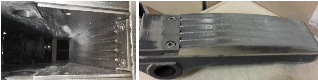
Figure 61 Concasseur à mâchoires, corps du concasseur (gauche) et mâchoire amovible en tungstène (droite)
