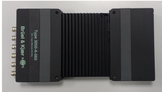
Figure III-14 : Analyseur FFT Brüel&Kjaer Type 3050-A-060
