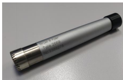
Figure III-21 : Microphone Brüel&Kjaer Type 2669
