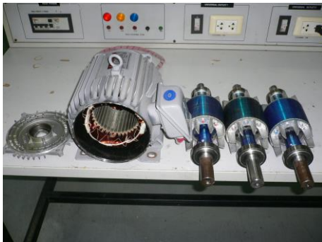
Figure I-30 : Machine asynchrone avec trois rotors : un droit, un vrillé de 5° et un vrillé de 10° [45]
