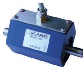
Figure III-3 : Couplemètre SCAIME DR2477-50N.m
