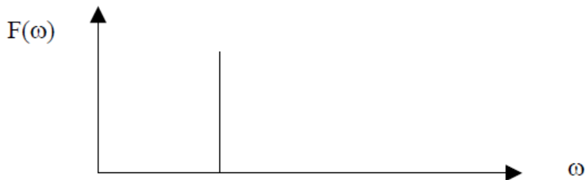
Figure III-5 : Spectre d'un signal avec une harmonique [73]
