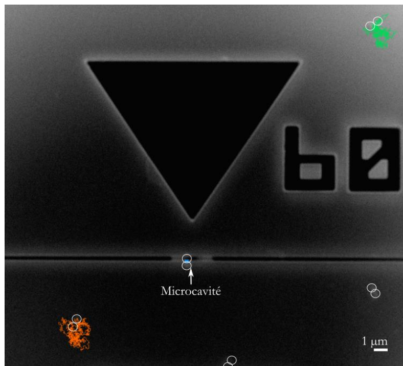
Fig. V.4 – Exemple de trajectoires de diplococcus de S. epidermidis piégés (bleu) et libres (non-piégés, trajectoires orange et verte) sur 50 secondes. Les bactéries sont repérées par un cercle blanc.
