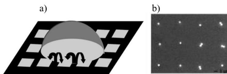
Figure 4.10 : a) Evaporation d'une goutte reposant sur un échantillon comportant des zones hydrophobes et hydrophiles, b) Assemblage de particules uniques 95 .
