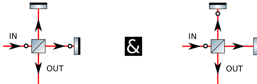
Figure 4.3 – Interférence à photon unique. Lorsqu'un photon est injecté dans un interféromètre de Michelson, il se propage dans ce dernier en étant en superposition cohérente entre les deux bras. Toutefois, une condition est nécessaire pour observer cette interférence à photons uniques : le déséquilibre temporel de l'interféromètre doit être inférieur au temps de cohérence du photon.
