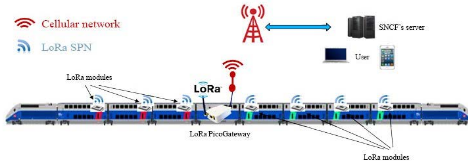
Figure 2. 6: Architecture de capteurs d'un train de la SNCF 8
