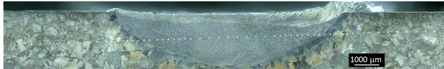
FIGURE 3.14 – Position des points de dureté
