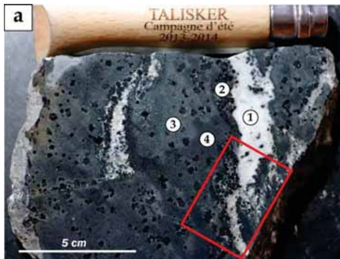
Figure 4.1 : a) Basaltes de plateau au contact avec le SRBIC. a) échantillon poli du mont du Commandant (13TK11). b) lame mince en LSP. c) Schéma de lame mince représentant les zones de composition minéralogique différente. d) lame mince en LPA.
