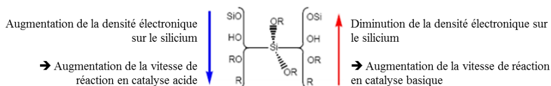
Figure 33 : Effet inductif des substituants présents sur l'atome de silicium sur les vitesses de réaction (adapté de Collignon, 2008)
