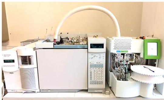
Figure 75 : TD-GC-FID pour la quantification des COV et la détermination des taux d'émission (source IMT Lille Douai).
