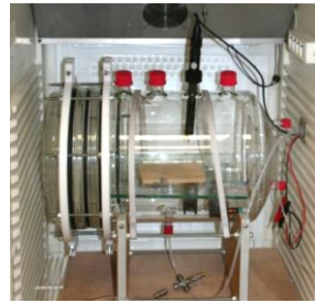
Figure 9 : Chambre d'essai d'émission (V = 10L) ; IMT Lille Douai.
