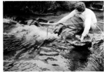
FIGURE 1.1 – Leighton mesurant le son produit par les bulles près d'une cascade à l'aide d'un hydrophone. Issu de [Leighton and Walton, 1987].
