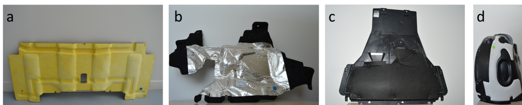
FIGURE 1.12 Différents types d'écrans acoustiques placés dans un compartiment moteur : (a) écran sous capot, (b) écran de tablier, (c) ski, (d) pare boue.
