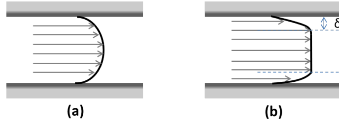
FIGURE 2.4 Schéma des profils de vitesse particulière dans un pore de section cylindrique (a) basse fréquence, (b) haute fréquence.
