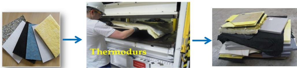
FIGURE 1.15 Transformation des matières par thermocompression : matières avant thermocompression ; presse ; matières produites.
