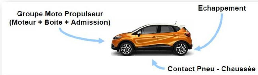
FIGURE 1.2 Principales sources de bruit de passage d'un véhicule.
