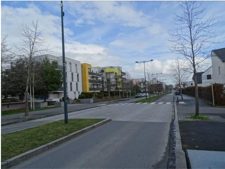
L'avenue centrale qui sépare le nord et le sud de l'opération est une voirie large avec un terre-plein central et des trottoirs surélevés et plantés de part et d'autre. Le choix de l'éclairage central permettra néanmoins d'éviter l'impact sur les arbres en cas de rénovation.
