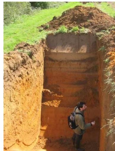
**Photo 76 : Pendant l'aménagement du Vallon des Saules (Bazin 2005) - A gauche, terrassement pour l'écoulement et la rétention dans des bassins successifs, à droite, fosse pour analyse de la composition du sol.**
