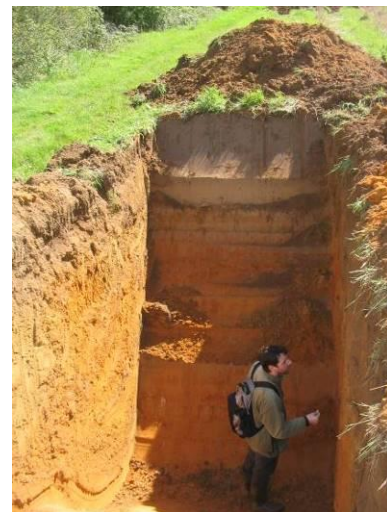
Photo 76 : Pendant l'aménagement du Vallon des Saules (Bazin 2005) - A gauche, terrassement pour l'écoulement et la rétention dans des bassins successifs, à droite, fosse pour analyse de la composition du sol.
