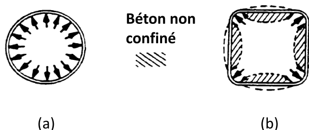
FIGURE 2.3 – Délimitation des zones du béton confiné par les armatures transversales : (a) béton confiné par des anneaux circulaires, (b) béton confiné par des cadres (Park et Paulay (1975)).
