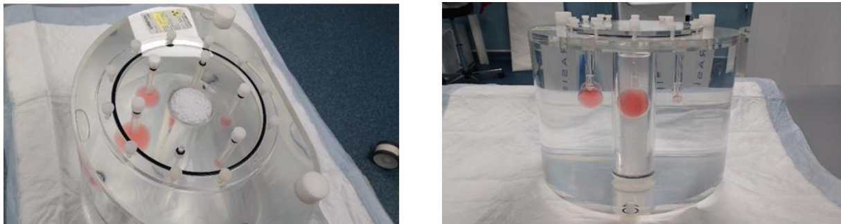
Figure 19 : Images du fantôme NEMA : remplissage des 6 sphères de différentes tailles avec une concentration de ^{18}\text{F} -FDG variable. Le fond du fantôme est également rempli avec une dose de ^{18}\text{F} -FDG correspondant à 1/10 de celle des sphères.
