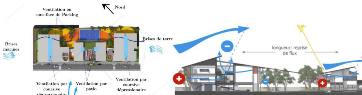
Figure 1.17: Principe et systèmes de ventilation de l'école
