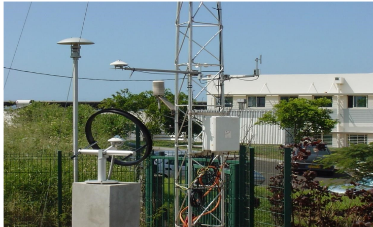
Figure 3.5 : Station météo de Terre Sainte utilisée pour la mesure des données climatiques
