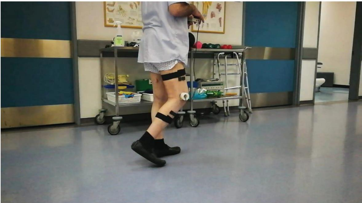
Figure 25. *Mesure de la flexion maximale du genou durant la phase oscillante avec un électrogoniomètre.*
