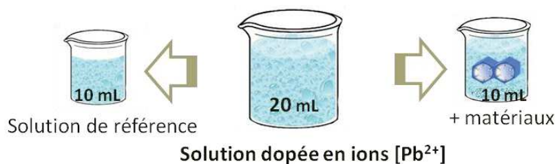
Figure 46 : Procédure de préparation des échantillons dopés en métaux lourds
