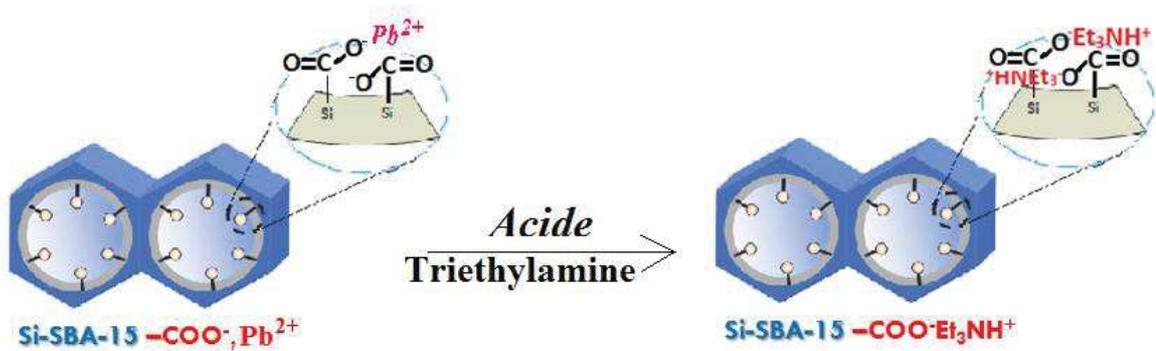
Figure 48 : représentation schématique de la régénérescence du matériau mésoporeux
