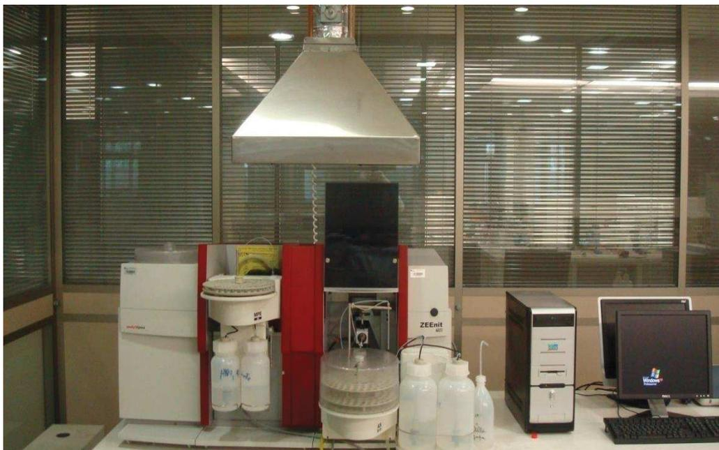
**Figure 67 : Spectromètre d'absorption atomique de modèle ZEEnit 700**
