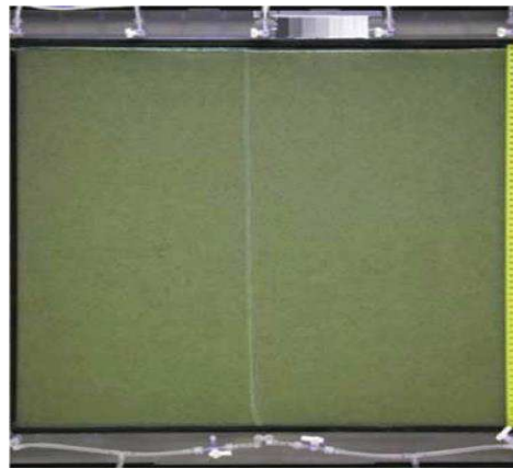
Figure 17 : Cellule avec la présence d'un précipité de calcite au centre
