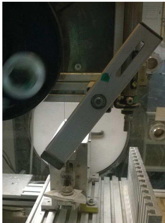
Figure 44 : Photo d'un échantillon de craie lors de sa découpe à la scie à fil (cellule C6)
