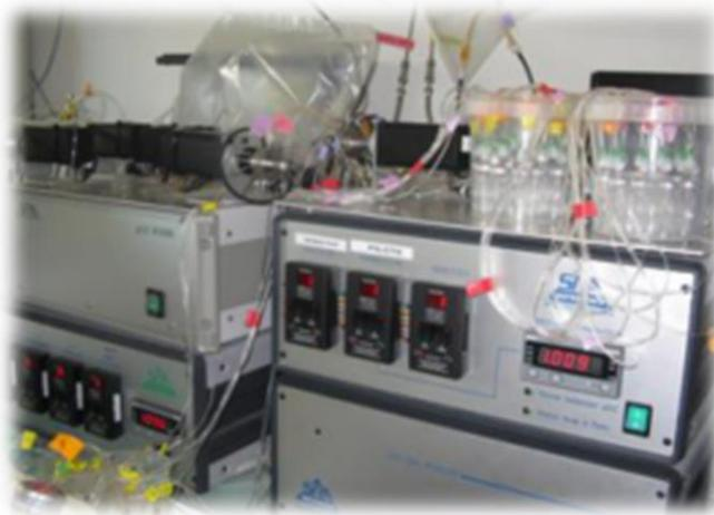
Figure 2-5 : Photo du micro-chromatographe en phase gazeuse multiplexé.
