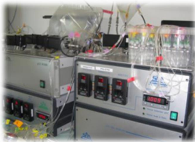
Figure 2-5 : Photo du micro-chromatographe en phase gazeuse multiplexé.
