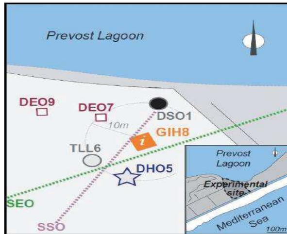
**Figure 48.** Dispositifs géophysiques et hydrodynamique sur le site de Maguelone, où les forages d'observation sont distribués sur un cercle de 10 m de diamètre. Son centre étant le puits d'injection GIH8
