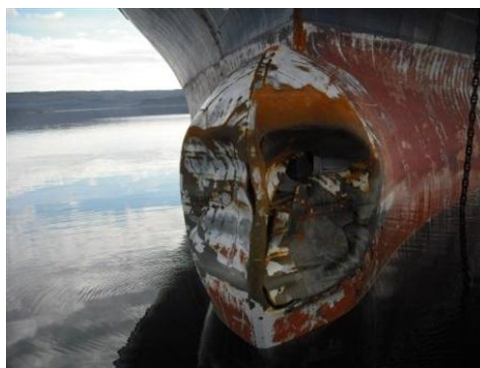
FIGURE 1.3 – Bulbe de bateau cassé par une collision avec une plaque de banquise. Photo extraite du site des garde-côtes canadiens ( http://www.ccg gcc.gc.ca ).
